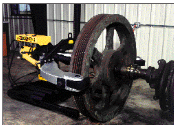
◀ Un EPH-1002 rimuove facilmente e velocemente questa puleggia dal suo albero.
