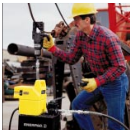
◀ Una pompa Titan PUJ-3309E usata con un tagliacavi oleodinamico.
